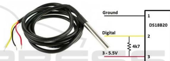
Figure 8: The temperature sensor. Model DS18B20.
