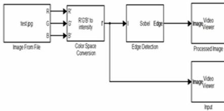
Fig 6: Edge detection Simulink model
